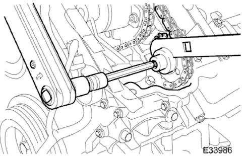
5. Install the camshaft sprocket.
